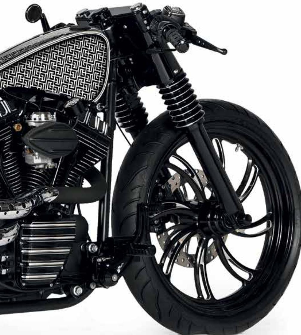
Die Kühlrippen der Zylinder sind im Diamond-Cut gefräst, das ist nur in den USA so zu kriegen
