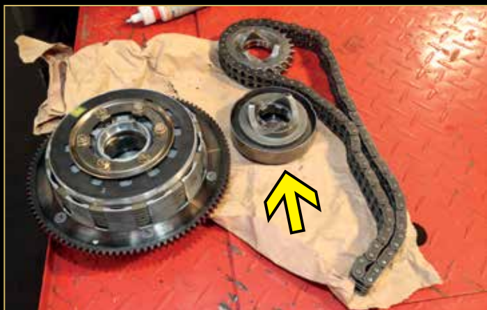
Oben: Echtes Leitungsgefummel ist angesagt, denn laut BBO-Reglement muss auch die gesamte Elektrik des Fahrzeugs auf der Bühne installiert werden. Unten links: Zu sehen ist der komplette Primärtrieb inklusive des Abtriebs-Ruckdämpfers (Pfeil). Unten rechts: Filigranarbeit – hier arbeitet Piotr von Guli Customs an den blattvergoldeten Tankemblemen
